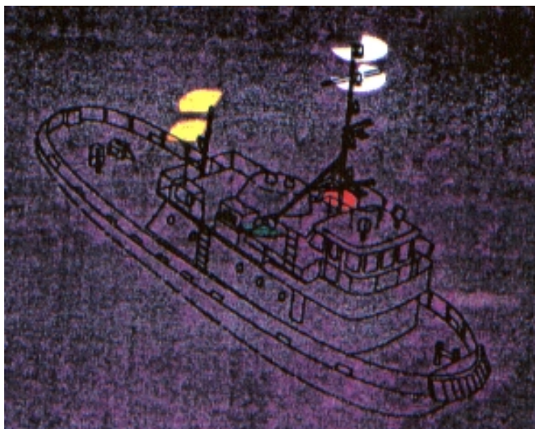
Fig. 11: Embarcação de propulsão mecânica que empurra em direção à proa ou reboque a contrabordo. Rebocador de menos de 50 m. de comprimento.
