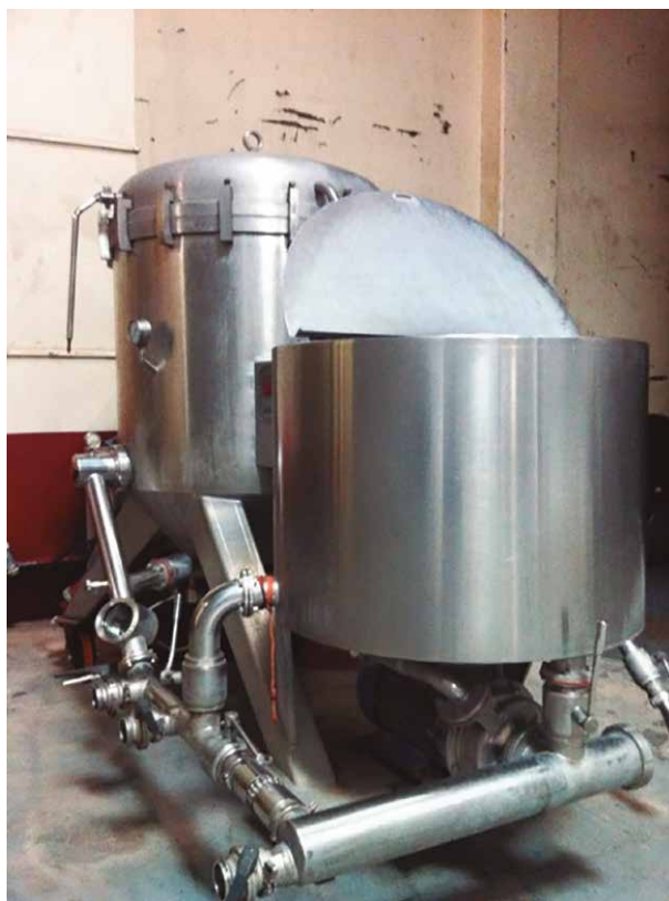
Figura 10 – Equipamento para filtração de cerveja com auxílio de terra diatomácea
