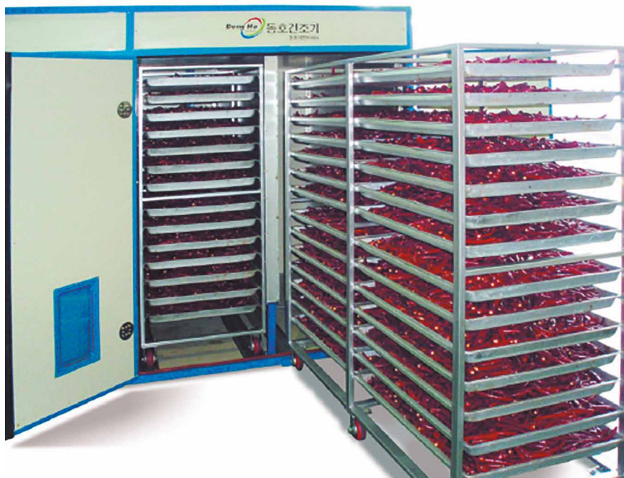
Figura 54 – Secadores de bandejas para frutas e vegetais com circulação de ar
